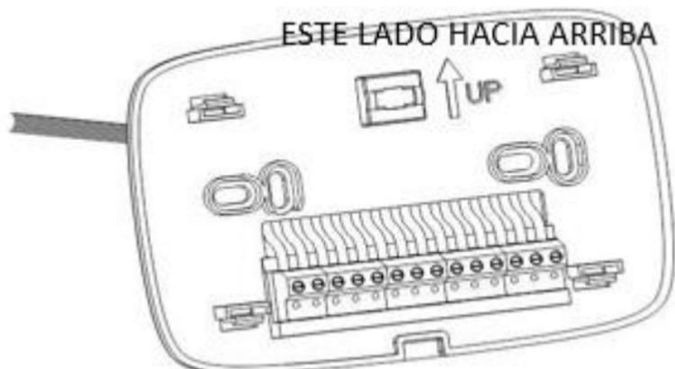
Fig.7 Inserción de los alambres en la regleta de terminales
